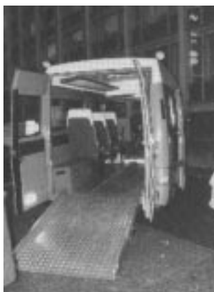
写真5 戸口輸送型STサービス車（ドイツ、ベルリン） アルミ製スロープ付き、この他リフト付きミニ バスもある。
