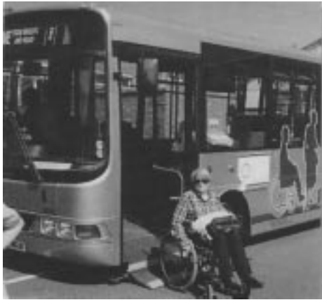
写真1 ノンステップバス（イギリス、ロンドン） 床下からスライド式に出てくるスロープ。
