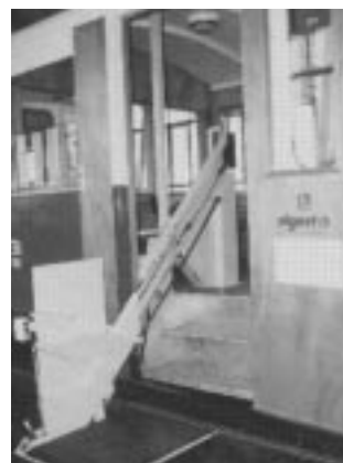
写真6 リギ登山鉄道（スイス、チューリッヒ） アルト・リギ鉄道（ARB）客車の出入口に取り 付けた電動リフト、肘掛けと座面を折りたた むと、車いすも使用可能。
