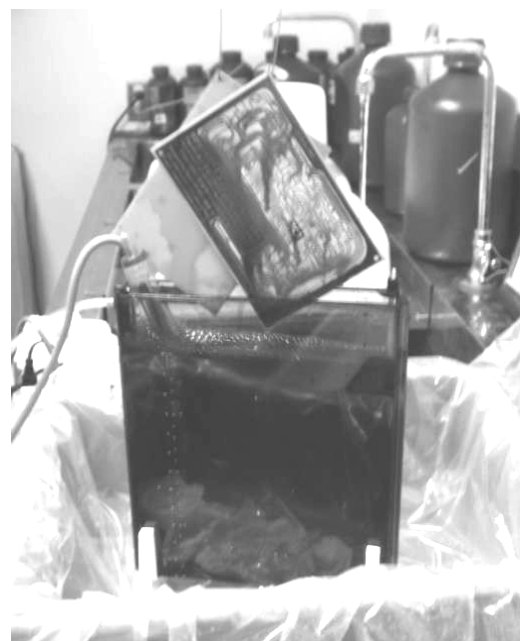
図4 エッチング中のポジ感光基板
