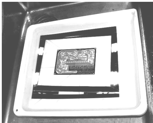
図2 転写が完了し、水洗い中の原版フィルム
