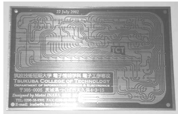
図3 現像の完了したポジ感光基板
