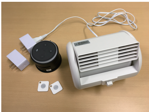
図3 デモで使用したデバイスの一部（スマートスピーカー、スマートタグ、スマートプラグと扇風機）
