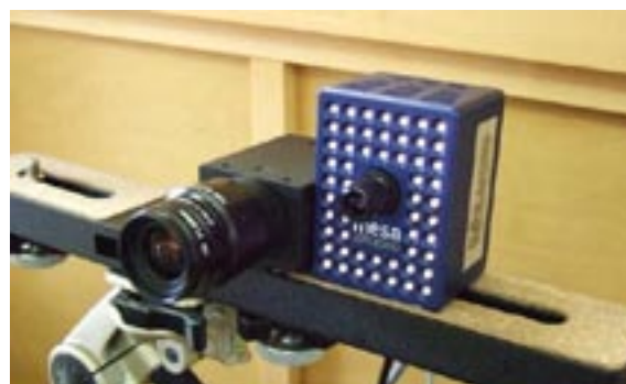
図 4 試作した立体映像撮影用カメラシステム (左が PointGreyResearch 社の Grasshopper, 右が MESA 社の SR-3000)
