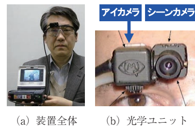
図1 眼球運動計測装置：モバイル・アイ
