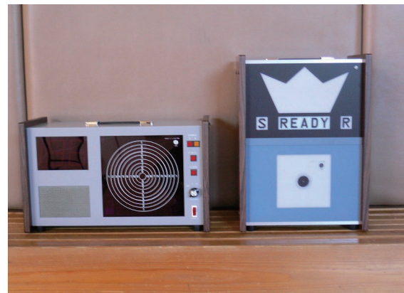
図2 右：ビームライフル標的装置（201型） 左：ビームライフル表示装置（201型）
