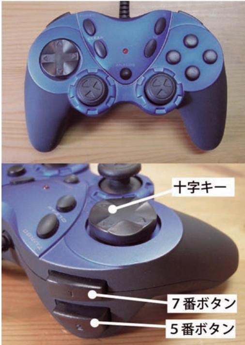
図2 ゲームパッドの外観（上）と左側のボタン群（下）
