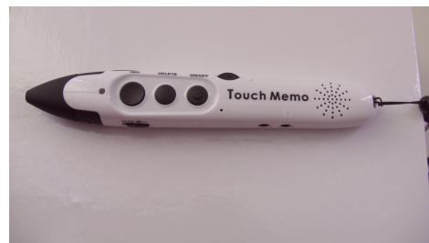
図1 ボイスペン 左から、REC（録音）、DELETE（消去）、ON/OFF の3つのボタンのみで操作可能である
