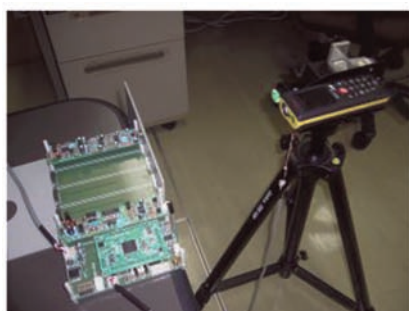
図 4 可視光通信のデータ通信実験
