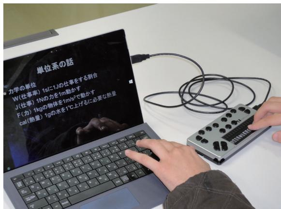
図6 Windows Tabletによる点字電子黒板 (Tabletにkeyboardを接続している)
