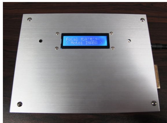
図5 温度計測回路をアルミケースに入れた状態
