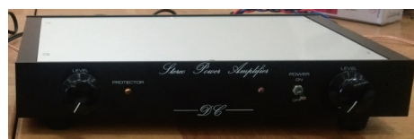
写真 3 再生アンプ : 自作 DC アンプ (Li-ion battery)
