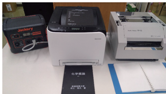
図5 墨字・点字プリンターとバッテリー電源
