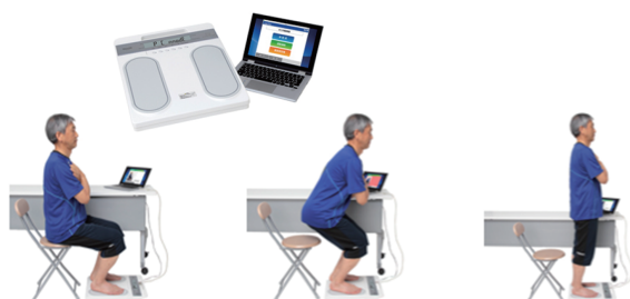
図2 運動機能解析装置 (zaRitz BM-220) と測定例
