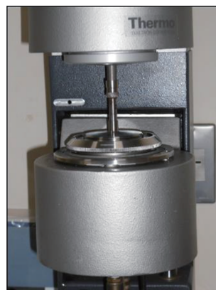
図1 せん断粘度測定のための円錐平板回転型粘度計
