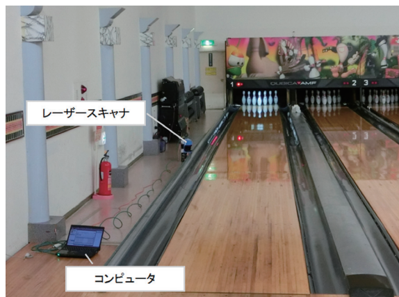
図2 レーザースキャナによるデータ取得
