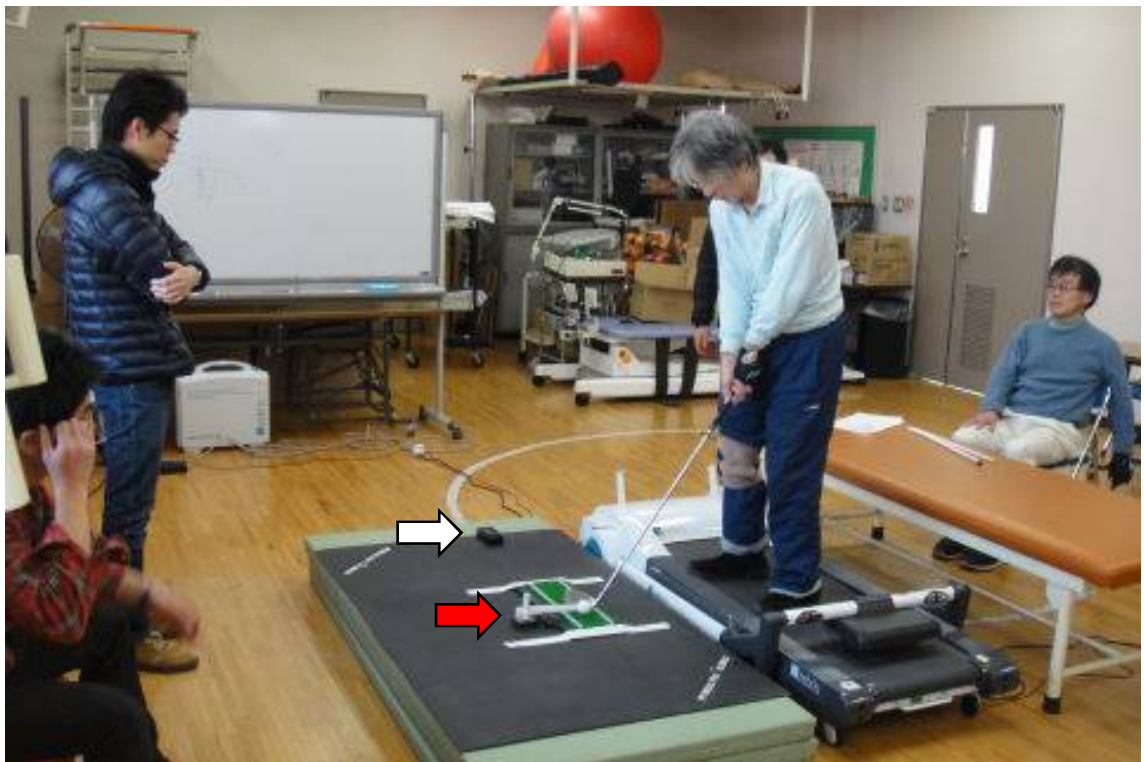
図 6. 重心動揺計付きトレッドミルとゴルフスイング距離測定機を用いた実験風景 重心動揺計付きトレッドミルの上でアドレスし、ボール付き練習用マット（赤矢印）のボールを打ち、重心動揺面積を測定した。同時に、飛球線の後方にゴルフスイング距離測定機（白矢印）を置き、推定飛距離を測定した。
