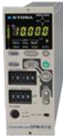
図 14：増幅器（共和電業 DPM-911B，出力：±10V，測定チャネル数：1）
