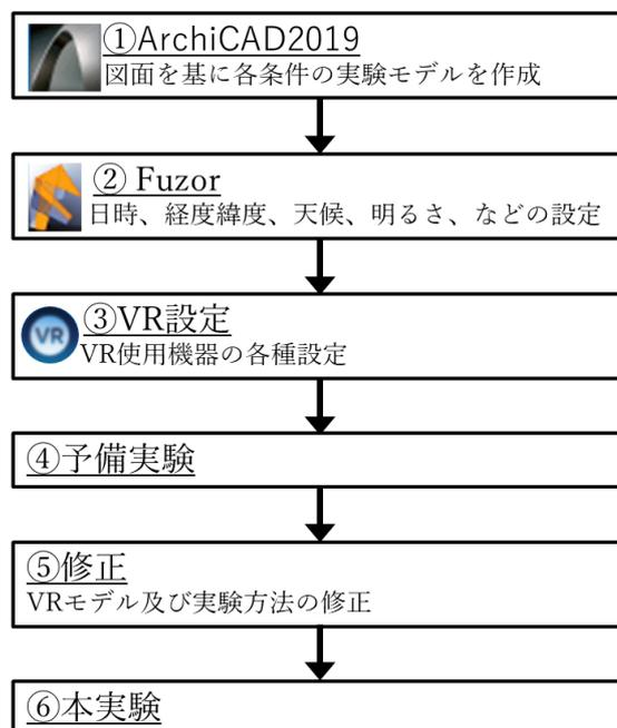
図 13 実験モデル作成から実施までのフロー図
