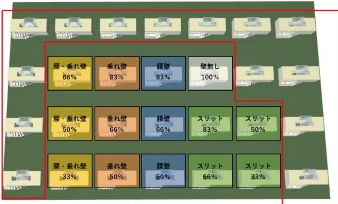
図 14 ArchiCAD2019 内での各窓ガラス条件の配置列
