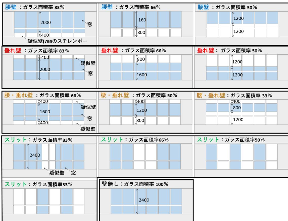
図 2 REAL 実験及び VR 実験で評価する窓ガラス条件
