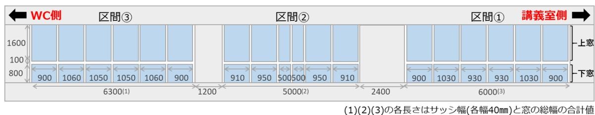
図 9 外通路から片廊下を見た時の区間①～③の各窓ガラス寸法
