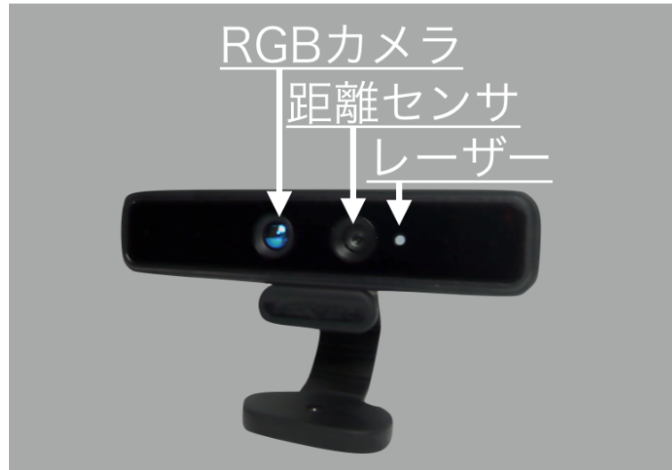
図 3.2: DepthSense325 の外観と各部の名称
