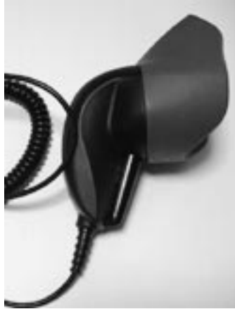
写真6 鼻口部を覆うマスク型のマイクロホン
