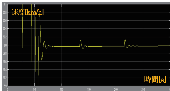
図10 PID制御の結果(外乱あり, K_i=5 , K_d=1 のとき)
