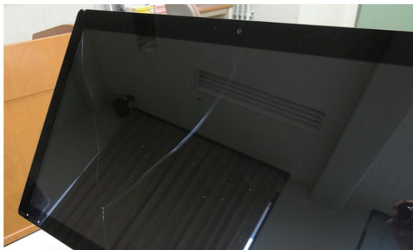
図3 ガラスにひびの入った例
