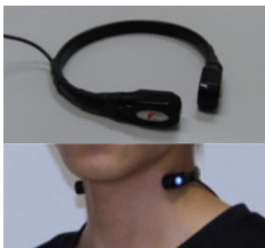
図1 頸部装着型嚥下機能計測機器 上: 本体写真。先端にコンデンサーマイクがあり嚥下音が取得される。下: 頸部装着時。
