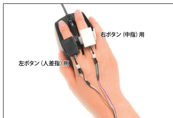
図2 SZCATを着用してマウス操作を行っている様子 Figure.2 Image of operating mouse using SZCAT
